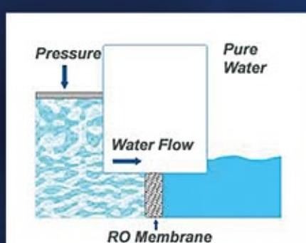
• **اسمز معکوس** Reverse Osmosis (RO)، متداول ترین روش در تهیه آب خالص می‌باشد. در این فرآیند، از یک پمپ و یک غشای نیمه تراوا استفاده می‌شود، پمپ، نیرو رانش را مهیا می‌کند. غشای نیمه تراوا بین آب و ماده حل شده، تمایل داردکه آب را از خود عبور دهد، بنابراین اکثر ماده حل شده در پشت غشای باقی می‌ماند.
