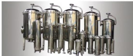
• **فیلترهای شنی** Multi Media فیلتر شنی یا Multi Media مخصوص حذف فیزیکی املاح و ذرات معلق در آب است. جنس بدنه این فیلترها از جنس ورق استیل، FRP و یا ورق کربن استیل می باشد. جنس بستر فیلتر از جنس سنگ سیلیس و یا انتراسید تشکیل شده است. عمده کاربرد فیلترهای شنی در پیش تصفیه RO - فیلتراسیون آب هایمعدنی - و فیلتراسیون استخیر های شنا و استخیرهای پرورش ماهی می باشد.
